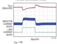
V<sub>OUT</sub> = 5V 300mA TO 6A LOAD STEP FIGURE 10 CIRCUIT
