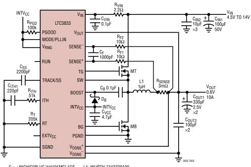
C<sub>IN1</sub>: NICHICON UCJ1H101MCL1GS C<sub>OUT</sub>: SANYO 2R5TPE330M9 D<sub>B</sub>: DIODES INC. SDM10K45
