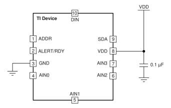
Figure 9-9. ADS1115-Q1 Power-Supply Decoupling
