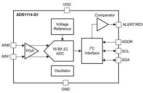
Figure 8-2. ADS1114-Q1 Block Diagram
