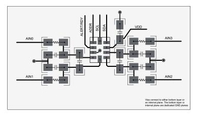
Figure 9-12. ADS1115-Q1 UQFN Package
