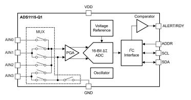
Figure 8-1. ADS1115-Q1 Block Diagram
