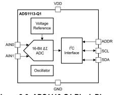
Figure 8-3. ADS1113-Q1 Block Diagram
