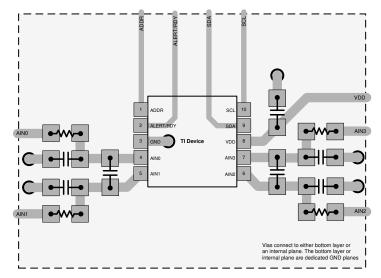
Figure 9-11. ADS1115-Q1 VSSOP Package
